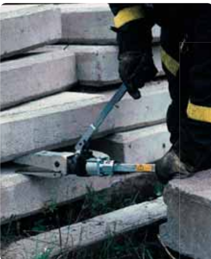
Handbetriebenes Spreizwerkzeug mit einer Leistung von 4,5 t.
