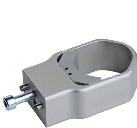
Verstellbare vertikale Halterung Gewicht 0,4 kg Drehmoment \leq 50 Nm ATH-4050-75 ( \varnothing=40-50 mm) ATH-5060-75 ( \varnothing=50-60 mm)
